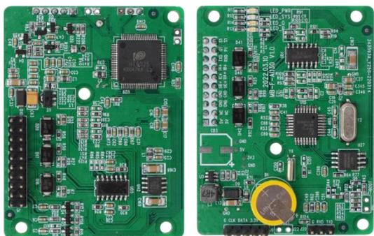
F-AI130 嵌入式 1 路线损模块是一种插板式模拟小信号线损模块,适用于 FTU、分散式 DTU 等配电自动化终端的产品。模块可直插在配电终端内部的线路上,为终端提供线损计算所需的电量信息,是配电线路精细化线损管理系统的重要组成部分。其性能、功能和通讯规约符合国网配电一、二次融合柱上开关技术条件。模块可实现三相电流、电压、有功/无功功率、功率因数、频率参数的监测以及有功/无功电能等数据的计量和计算。采用 TTL 串口通信,遵循 DL/T 634.5101-2002 协议及其备案文件;有功电能计量精度符合 GB/T17215.322-2008 (静止式有功电能表 0.5S) 中的规定;无功电能计量精度符合 GB/T17215.323-2008 (静止式无功电能表 2 级) 中的规定。
