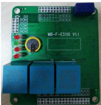
F-ES110 嵌入式 1 路电子式(电流)+电磁式(电压)线损模块是一种基于电压/电流互感器的 10KV 配电高压计量装置, 为 10KV 配电线路分段点、分支点、柱上开关、环网柜等设备节点处的高压电能计量和实时监测的需求提供解决方案, 是 10KV 配电线路精细化线损管理系统的重要组成部分。集测量、计量、通信功能于一体, 支持 TTL 串口通信。
