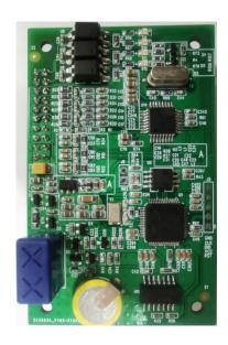
F-AI100 嵌入式 1 路模拟量线损模块是一种基于电压/电流传互感器的 10KV 配电高压计量装置,为 10KV 配电线路分段点、分支点、柱上开关、环网柜等设备节点处的高压电能量计量和实时监测的需求提供解决方案,是 10KV 配电线路精细化线损管理系统的重要组成部分。集测量、计量、通信功能于一体,支持 TTL 串口通信。
