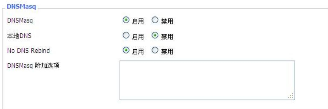
**本地 DNS:** 采用本地的 DNS，在设置页面中可以设置 DNS 服务器
