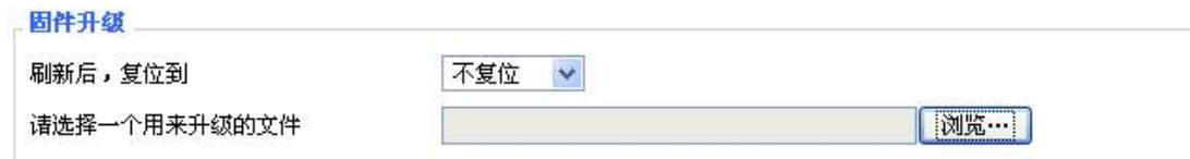
**固件升级:** 可将新的固件加载到路由器上。如果路由器没有出现问题，则无需下载更新的固件版本，除非新版本中包含您要使用的新增功能。
