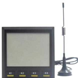
F-MPM200 多功能电力仪表是针对电力系统、工矿企业、公用设施，电力智能监控等需求而设计的一款产品。它能测量所有常规的电力参数，集测量、计量、通讯功能于一体，支持串口通讯和蜂窝网络通讯。
