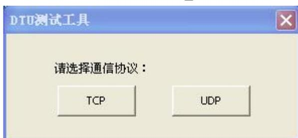
F2924-D/DS 必需配置在 DCUDP 工作模式下。将终端设备 (比如 PLC，在这里我们用电脑模拟) 的串口与 F2924-D/DS 的串口相连，设备连接好后，将所需设备都上电。
