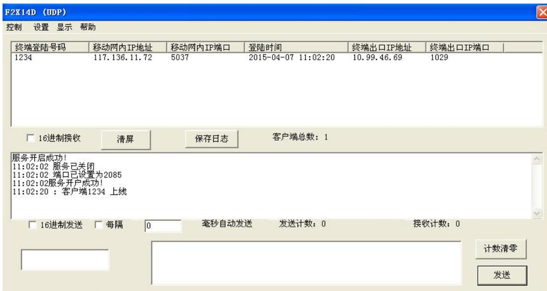
4、现在就可以测试 F2924-D/DS 与数据中心之间的通信，数据中心接收到的数据将显示在信息窗口，数据中心发送的数据将被远端设备接收。在这里，我们用的是一台电脑通过串口与 F2924-D/DS 连接来模拟远端设备（可以用超级终端或其他终端软件，在这里我们用的是一款串口工具）访问 F2924-D/DS 串口。
