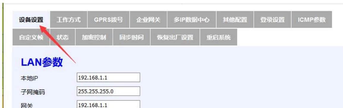
下载配置也需硬件检测正常并用浏览器登录，用户点击要设置的选项，待数据显示后设置好各项参数，点击“保存设置”，下载配置成功将在页面显示保存配置成功，如下图所示。保存成功后需要重启设备，配置生效。
