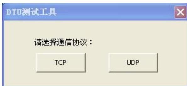
这样 F2X14D\_DC 软件就工作在 TCP 模式下，此时设备 F2924-D/DS 需配置在 DCTCP 工作模式下方可进行测试，接下来的测试步骤与 UDP 模式的类似。
