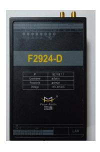
F2924-D/DS 系列电力级 DTU 是一种物联网无线数据终端,利用 GPRS/WCDMA/EVDO/LTE 网络为用户提供无线数据传输功能。
