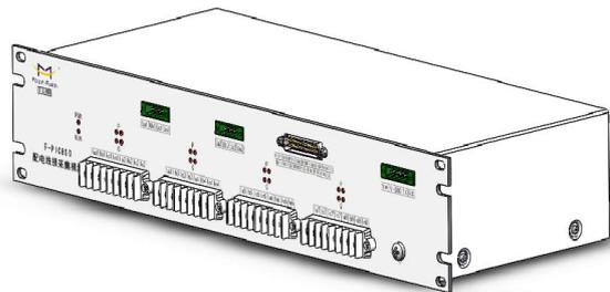
F-PIC800 配电线损采集模块是一种基于电压/电流传感器和电磁式互感器的 10KV 配电高压计量装置,为 10KV 配电线路分段点、分支点、柱上开关、环网柜等设备节点处的高压电能量计量和实时监测的需求提供解决方案,是 10KV 配电线路精细化线损管理系统的重要组成部分。集测量、计量、通信功能于一体,支持 RS232 或者 RS485 通信。
